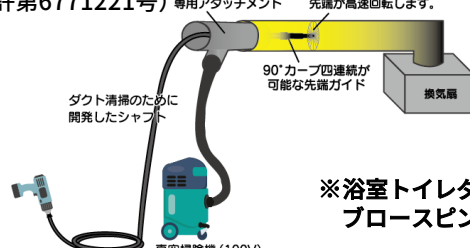
※台所ダクト清掃 ファイブスピン工法®
